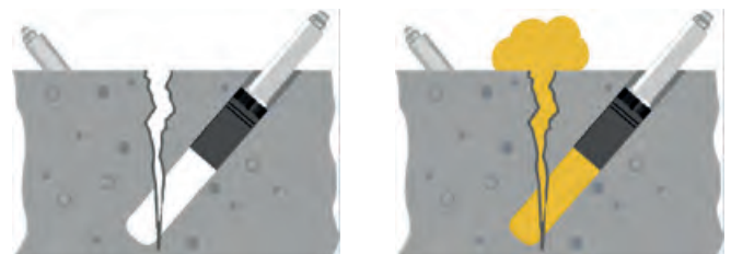
IN-8 boşlukları şişerek doldurur. IN-8 fills the voids by foaming.
